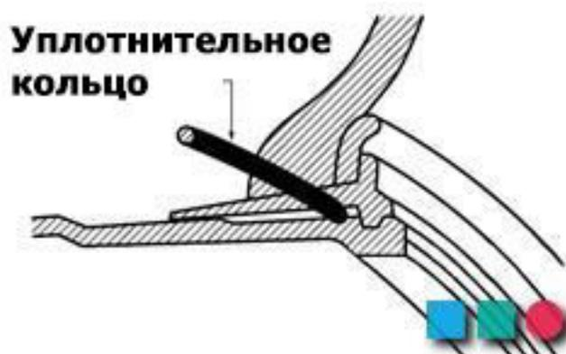
Очень важно правильно использовать эти кольца. Следует отметить, что даже если ободья имеют одинаковый диаметр, на них могут устанавливаться различные по конструкции кольца. Механик должен разбираться в используемых типоразмерах. Толщина колец является обязательным параметром для установки.
