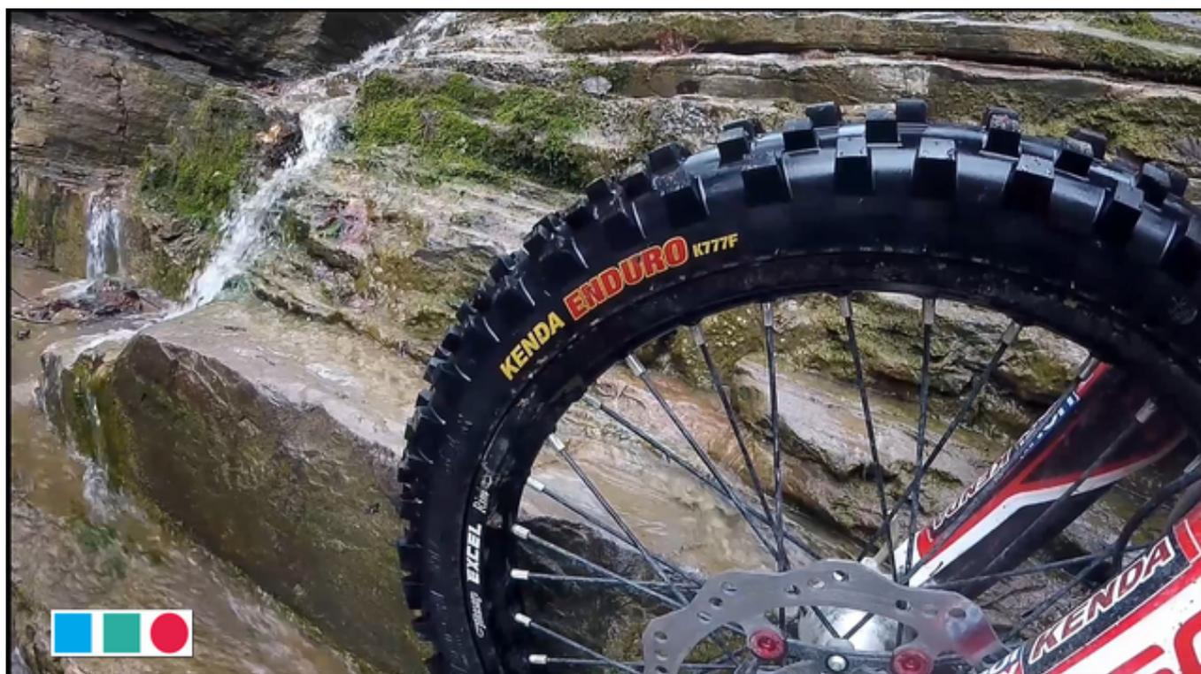
Шины Kenda K777F одобрены DOT. Передние и задние шины сертифицированы для FIM Enduro. Спортивные шины подходят для грязи 90% и 10% дороги.
