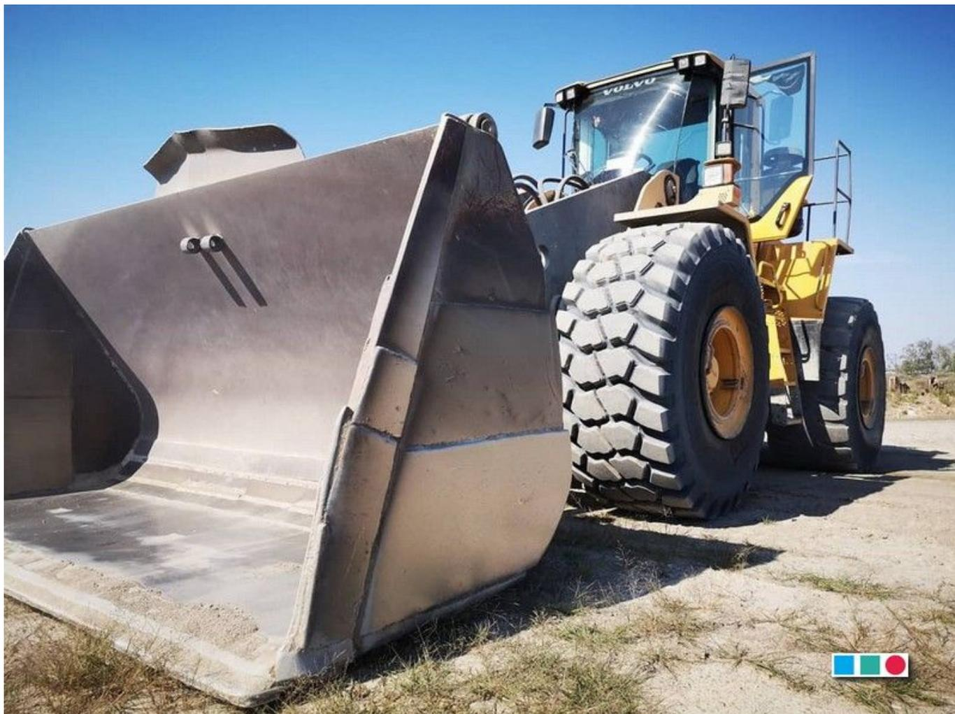
Earthmax SR 41 — это радиальные шины с цельным металлокордом для самосвалов с шарнирно-сочлененной рамой. Они идеально подходят для всех видов работ, требующих высоких тяговых характеристик и устойчивости. Эти шины также подходят для погрузчиков и бульдозеров.
